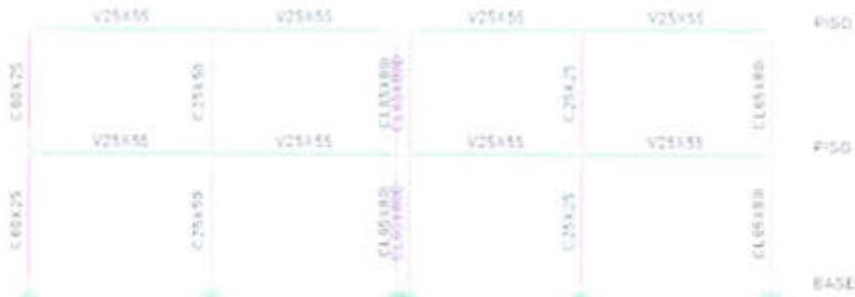
Ilustración 6 Secciones vista XZ (Eje A y B)
