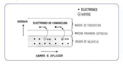
Donde: el hoyo se representa con una cruz dentro de un círculo (+), y los electrones con (●). Los electrones pasan de la banda de valencia a la banda de conducción donde se dirigen en sentido contrario.
