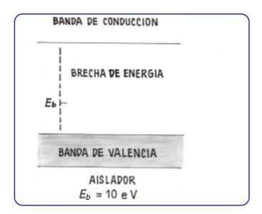
Los semiconductores tienen una brecha de energía aproximadamente de 1 eV a 0°K, así estos materiales son malos conductores a bajas temperaturas pero a una temperatura de 300°K (23°C), esta conductividad aumenta grandemente. Así, los electrones pasan rápidamente de la del campo donde se encuentran los electrones en reposo (zona llena o banda de valencia) a la zona llena o banda de conducción.
