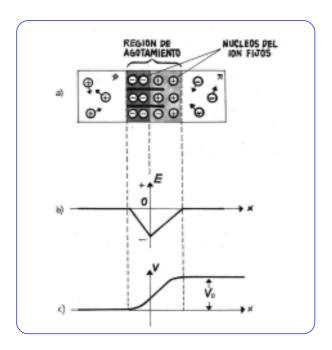
Este diodo que es un dispositivo de dos terminales tiene la propiedad de pasar corriente eléctrica en una sola dirección, además de poseer una gran resistencia al paso de la corriente eléctrica en una zona y una baja resistencia en la otra.
