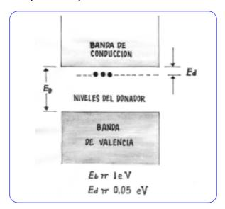
En este caso la impureza dona un electrón por lo que se le denomina **átomo donador.** En la gráfica se observa que existe un espacio muy pequeño entre la banda de conducción y los niveles del donador (aprox. 0.05 eV), por lo que se necesita una pequeña cantidad de energía térmica para que el electrón se introduzca en la banda de conducción. A los semiconductores dotados con átomos donadores se les conoce como **semiconductores tipo** *n*
